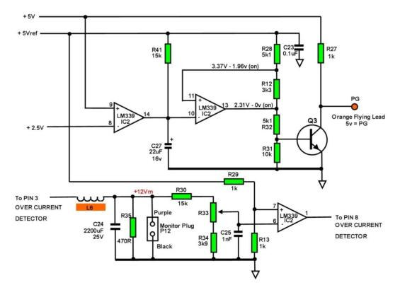
IBM-5155 POWER SUPPLY - POWER GOOD CIRCUIT & AMBER CRT MONITOR PARTIAL CIRCUIT.
