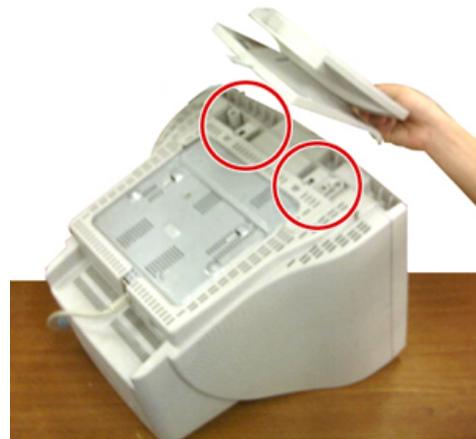
2. Alignez les crochets sur la base avec les fentes au bas du moniteur.
