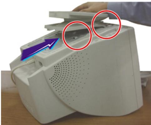
3. Pressez la base jusqu'à ce que les crochets soient entièrement engagés dans les fentes.
