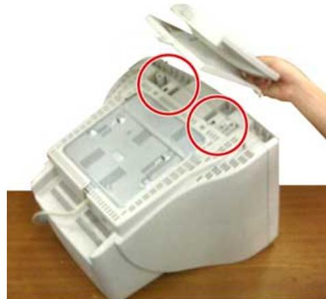
2. Halten Sie die Haken am Fuß an die entsprechenden Schlitze auf der Unterseite des Monitors.
