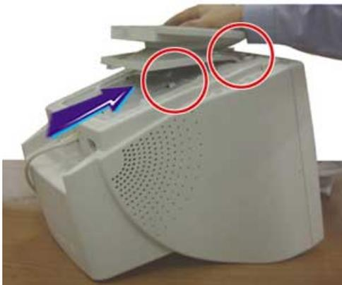
3. Presione la base en el monitor hasta que las lengüetas estén completamente insertadas en las ranuras.
