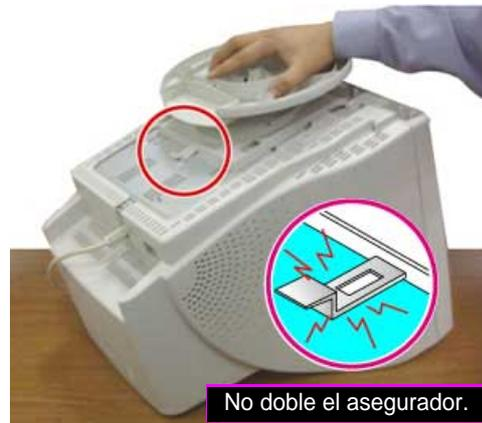
4. Presione la base hacia la parte anterior del monitor hasta que los picaportes disparadores hagan clic en la posición de ajuste.
