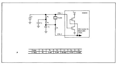
FIGURE 4. TYPICAL CRYSTAL OSCILLATOR NETWORK
